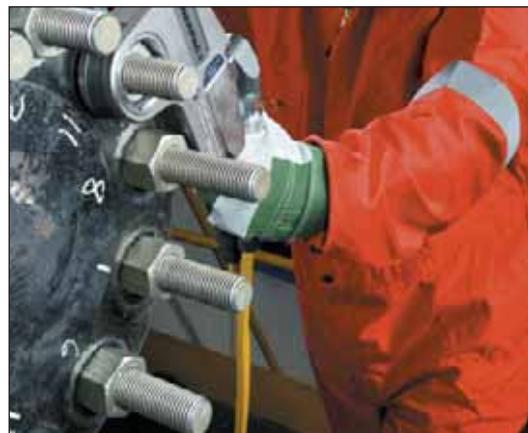
◀ La bomba clásica ZU4 para llaves de torque puede proporcionar energía a cualquier llave de torque hidráulica.
