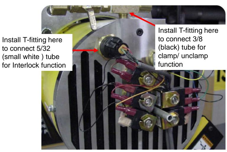
Adjust Interlock per Air Balancer/ RAH manuals
